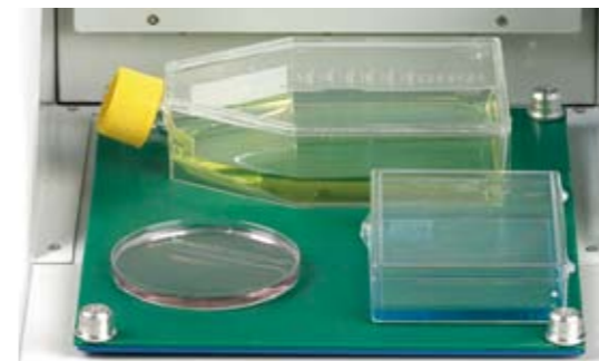
マグネチックプラットフォームには フラスコクランプを自在に配置可能
